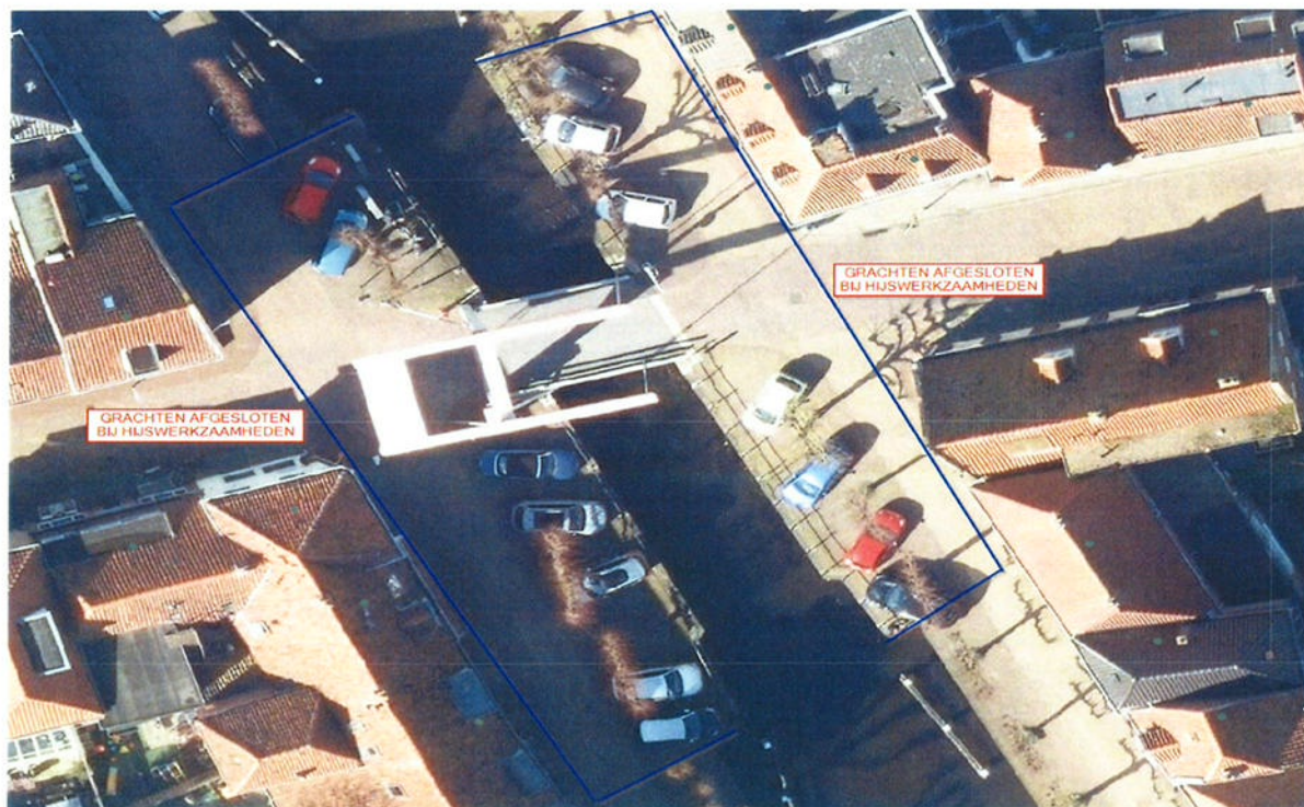
Af te sluiten gebied rondom de brug tijdens hijswerkzaamheden:
